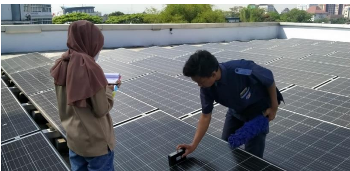
Gambar 2. Pengukuran Kebersihan Panel Menggunakan Gloss Meter
