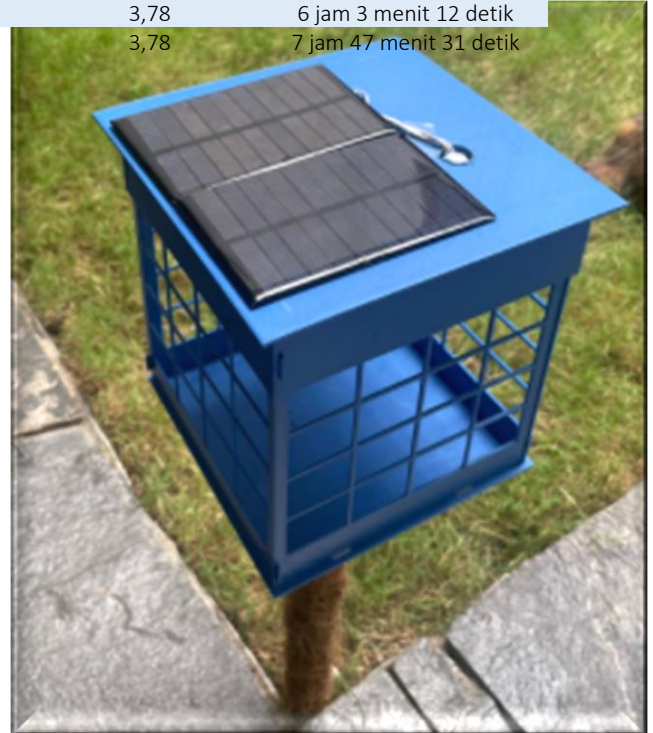
Gambar Lampu Hasil Cetak 3D Printing dan Kap Lampu Dilengkapi Rangkaian
