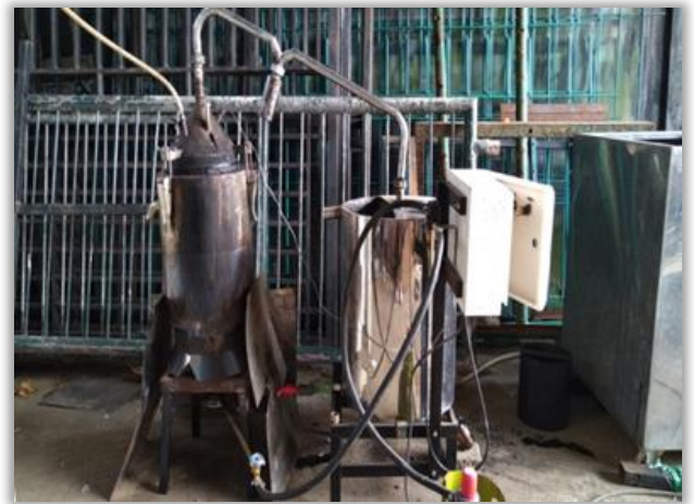
Gambar Reaktor Pirolisis
