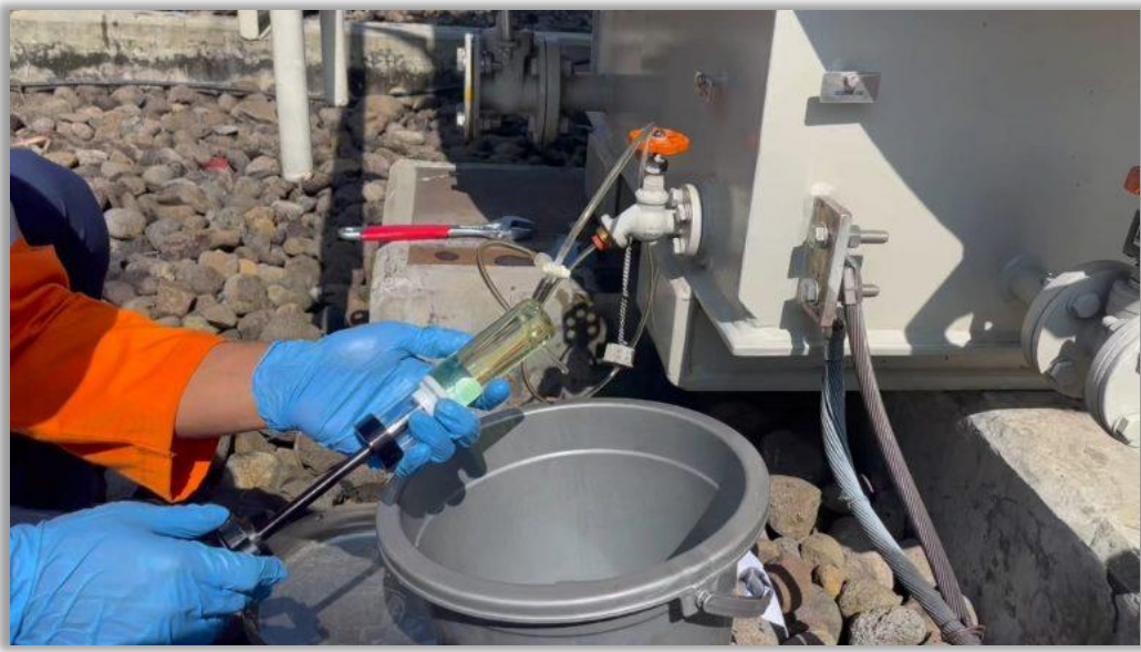
Gambar Ilustrasi pengambilan sampel minyak pada transformator yang beroperasi (kiri); Ilustrasi laboratorium pengujian minyak transformator (kanan)
