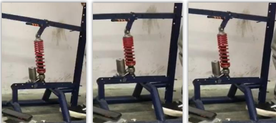
Foto uji laboratorium, foto kiri belum ada beban, foto tengah beban penuh dan foto kanan hasil pantulan dari pembebanan
