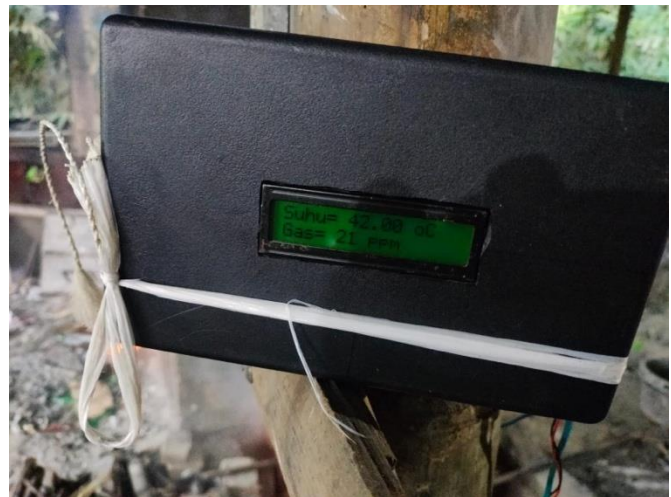
Gambar 2. Hasil Pembacaan Temperatur di Tungku Pembakaran dan Gas CO 2
