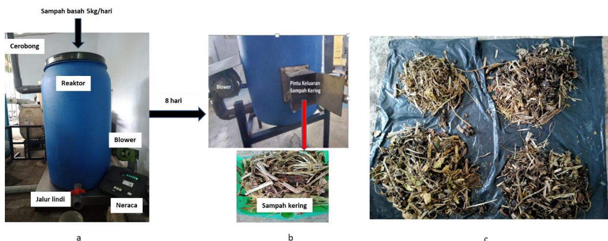
Gambar 2. Proses pengujian kinerja reaktor bio-drying kontinyu (a) Umpan sampah basah dimasukkan reaktor (b) Pengambilan sampah kering (c) Produk sampah kering
