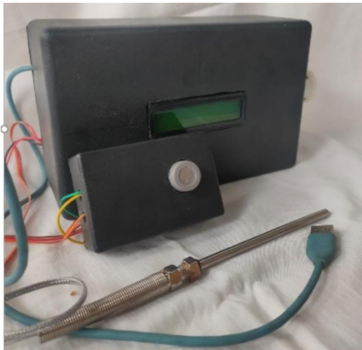
Gambar 1. Prototipe Sistem Pemantau Tungku Pembakaran Sampah Berbasis IoT
