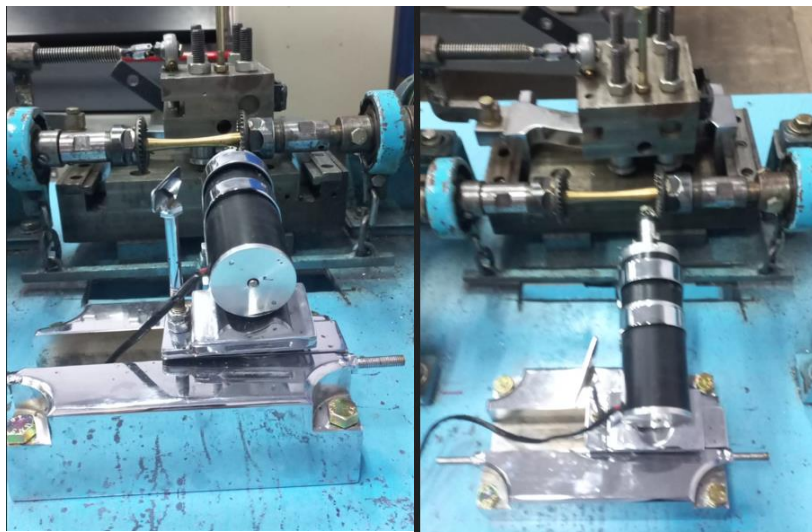
Gambar 2. Perangkat bantu Motor DC penggerak Mur Collet yang telah dilengkapi dengan pemasangan Roda Gigi Kerucut ukuran besar yang berpasangan dengan Ujung Poros Penggerak Mur Collet yang juga telah dilengkapi dengan Roda Gigi Kerucut ukuran kecil
